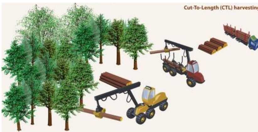
ILUSTRACIÓN 6. MÉTODO DE COSECHA MECANIZADO A MEDIDA CUT TO LENGTH
